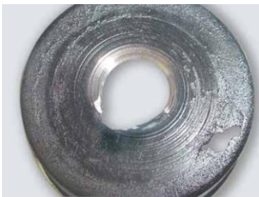
Proteção térmica danificada por fricção com o rotor de turbina causada por impulso axial. - Excesso de fumaça.
