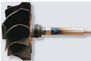
Desbotamento do eixo devido ao aumento de temperatura causado pela falta de óleo.
