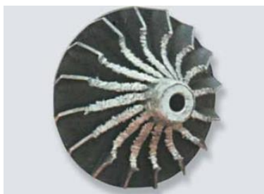
Exemplo típico de ingestão de um objeto estranho, como uma porca, arruela, etc.
