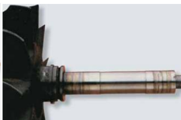
Deposição do material radial do rolamento no eixo.
