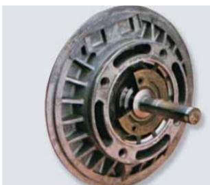
Desbotamento do eixo devido ao aumento de temperatura causado pela falta de óleo.
