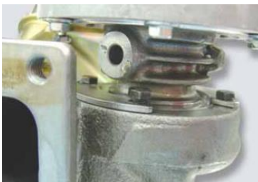
Alteração do parafuso de fixação da carcaça da turbina.
