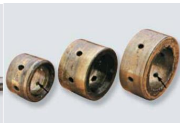
Mancal radial com orifícios de passagem de óleo entupidos.
