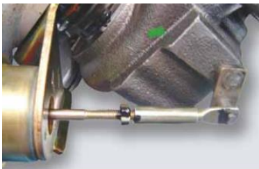
Exemplo de quebra de vedação da porca de ajuste da haste do atuador
