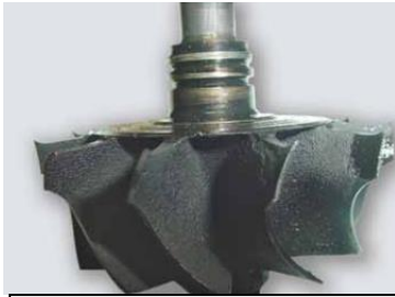
O exemplo de impulso axial na direção do compressor da turbina.
