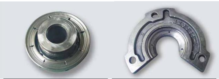
Desgaste devido ao atrito entre o colar e a frente da placa.
