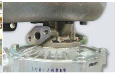
Alteração do parafuso de fixação da carcaça central na placa.
